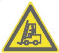
Границы опасной зоны **от воздействия движущихся машин, механизмов, их частей и элементов** должны определяться зоной в пределах 5 м от опасного объекта, если иное не предусмотрено указаниями в паспорте, инструкции завода-изготовителя.
