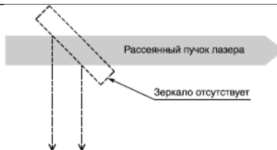
Рисунок В.4а - Работа лазера при отсутствии поворачивающего зеркала
