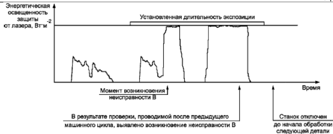
Рисунок В.6b - Отключение лазера при использовании автономного машинного мониторинга безопасности
