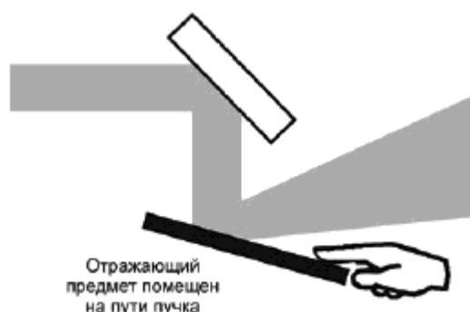
Рисунок В.4d - Отражающий предмет пересекает пучок лазера
