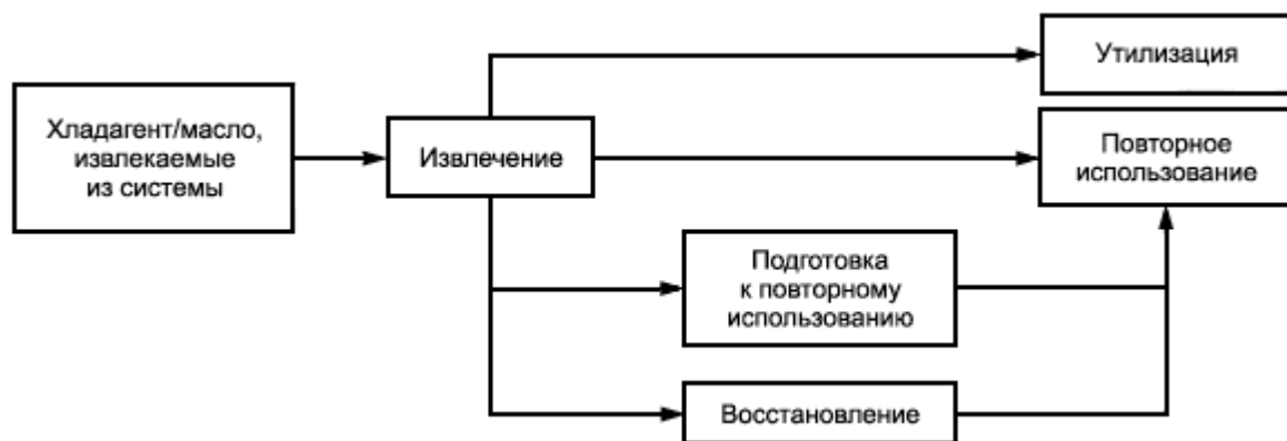
Рисунок 1 - Упрощенная схема взаимосвязи между различными процедурами
