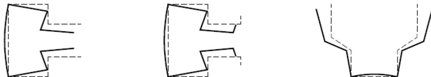
Рисунок 15 - Потеря устойчивости сечения сложной формы
