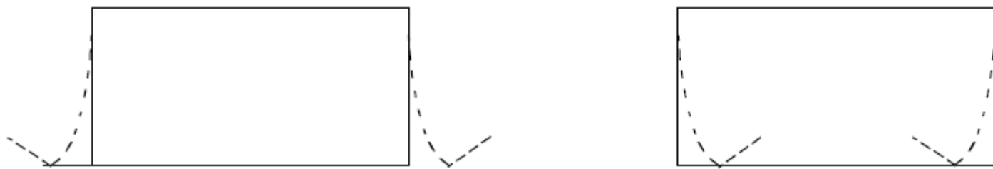
Рисунок 14 - Потеря устойчивости сечения простой формы
