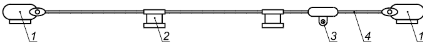
1 - концевой анкер; 2 - промежуточный анкер; 3 - мобильная анкерная точка; 4 - гибкая анкерная линия
