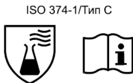
Рисунок 4 - Маркировка перчаток типа С
