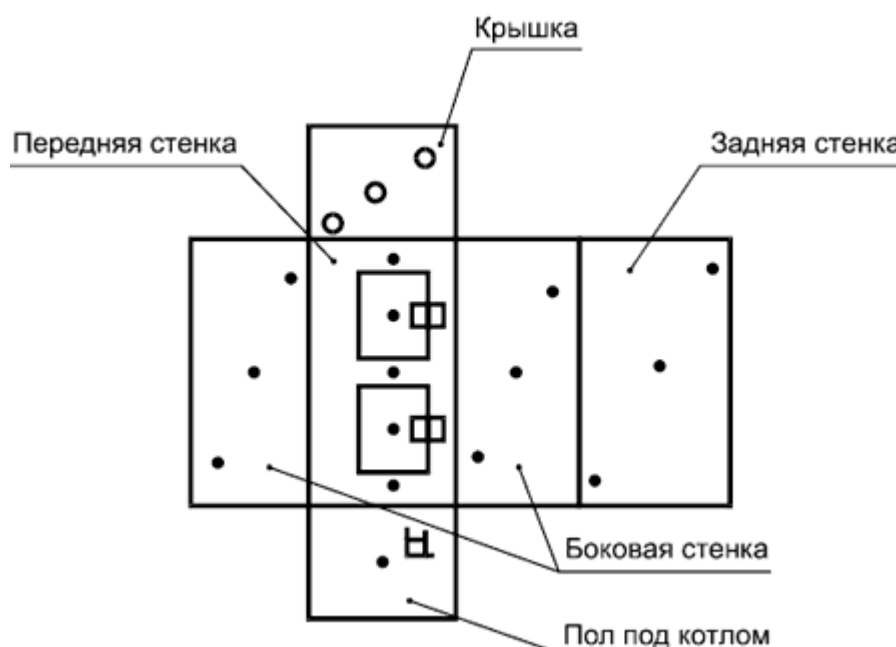
Рисунок 7 - Схема точек измерения температур наружных поверхностей котла и пола под ним
